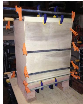
Installation des rails sur les côtés avant collage en utilisant des guides (6 côtés à faire) et collage des cabinets
