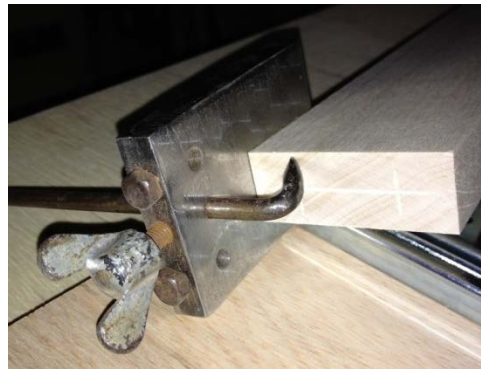
Trusquin en inox que j'ai fait quand j'étais a Sète (1967) avec pointe en tungstène
