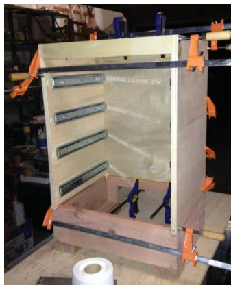
Installation des rails sur les côtés avant collage en utilisant des guides (6 côtés à faire) et collage des cabinets
