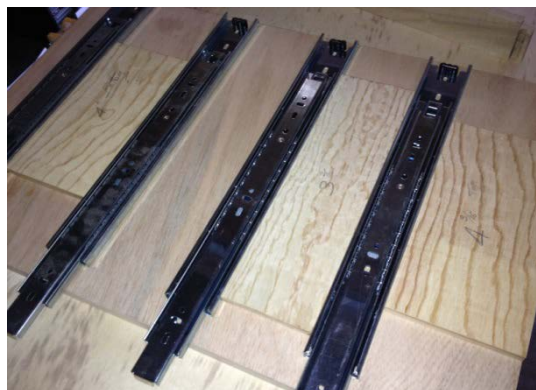
Installation des rails sur les côtés avant collage en utilisant des guides (6 côtés à faire) et collage des cabinets
